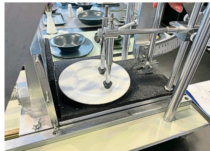
Dieses Testgerät prüft die Qualität, vor allem die Stabilität des extrem widerstandsfähigen Porzellans. Ein kleiner Schwinghammer trifft den Rand des Tellers – und der sollte davon unbeeindruckt bleiben.
